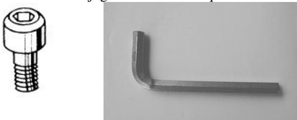
Figura 17. Parafuso e chave “Allen”
