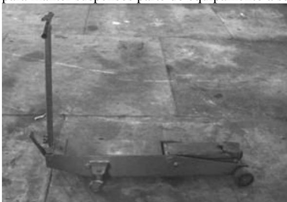
Figura 3. Macaco hidráulico
