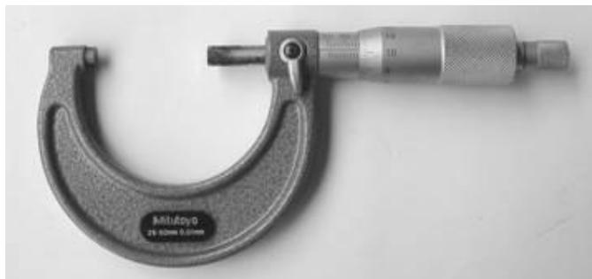
Figura 7. Micrômetro.
